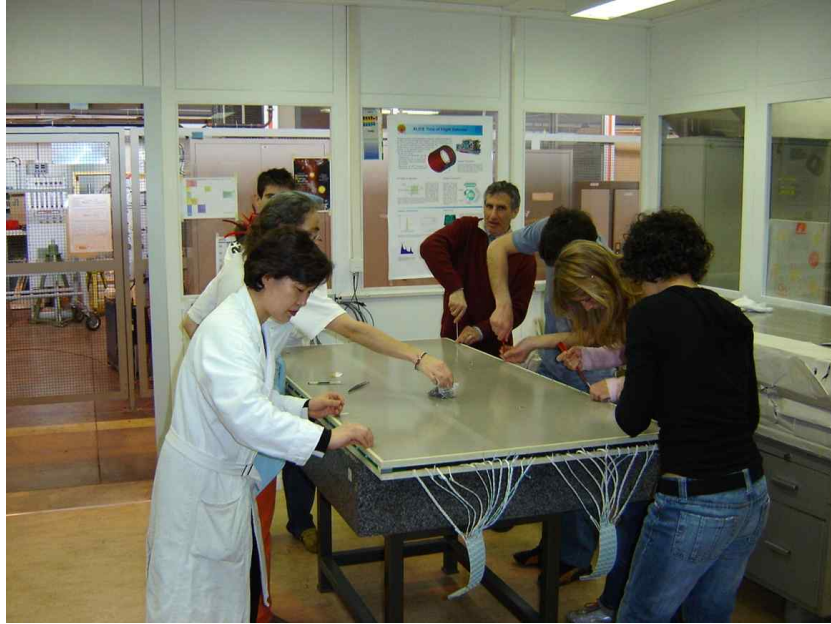
<그림 2> 이탈리아 고등학생들이 CERN에서 EEE 검출기를 제작하는 모습. 완성된 검출기 3개는 그 학생들의 학교로 운송된 후 설치되어 우주선 검출장치로 활용된다.
