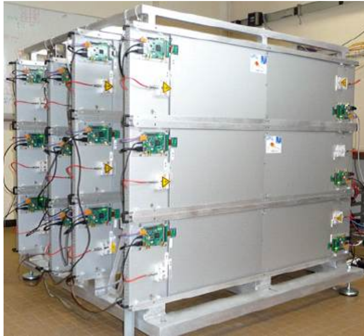
<그림 5> 24개의 RPC 들로 제작된 TOMUVOL 검출기의 모습. 각각의 RPC는 50cm x 33cm 크기이고, 이들이 6개씩 결합되어 1m x 1m 면적의 한 평면을 구성한다. 네 개의 평면으로 전체 검출기가 구성되었다.
